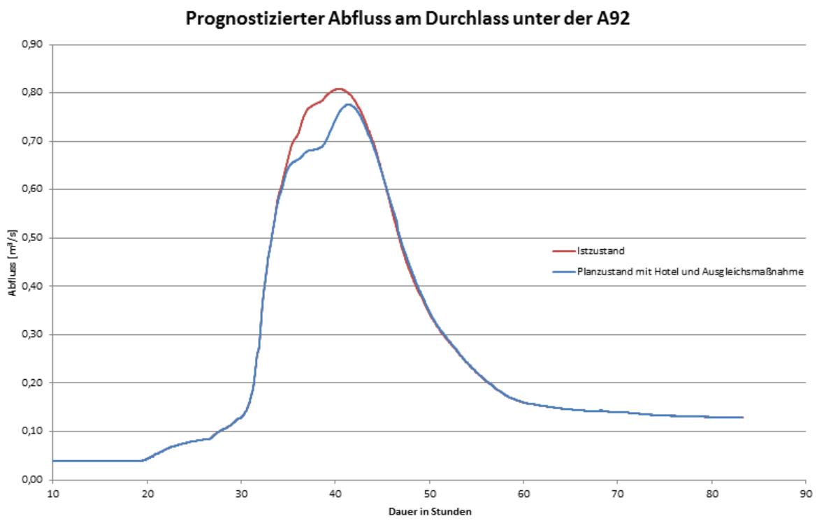
Abbildung 1: Prognostizierter Abfluss am Durchlass unter der A92
